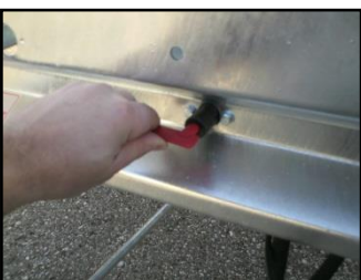
Bild 5: Hauptschalter auf EIN gestellt
