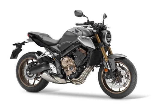
Das Honda Neo Sports Café Bike der mittleren Hubraum-Klasse erhält eine Showa 41 mm Separate Function Big Piston Gabel sowie EURO5-Konformität für seinen Vierzylinder Motor. Weitere Updates sind ein nach vorn versetzter Lenker, ein verbessertes LCD-Dashboard und ein USB Typ-C Ladeanschluss unter dem Sitz. Die neue Seitenverkleidung betont das minimalistische Styling.
