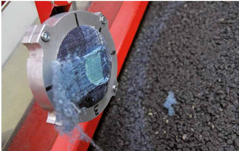
Bei der Zertifizierung treffen Materialproben mit definierter Geschwindigkeit auf Norm-Asphalt.
