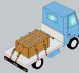
Schrägzurren in Längs- und Querrichtung
