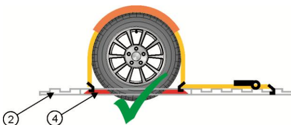
Abbildung 6: Zulässige 3-Punkt-Sicherung in Mulde
