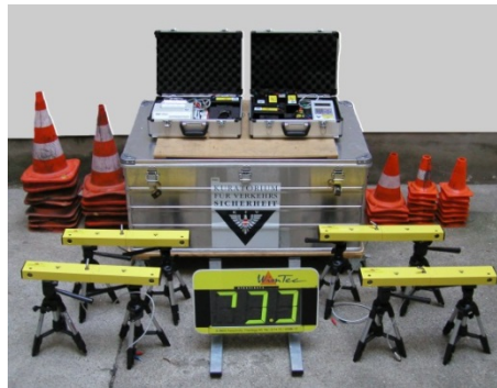
Abbildung 32: Zusammenstellung der Bremsverzögerungsmesseinrichtung
