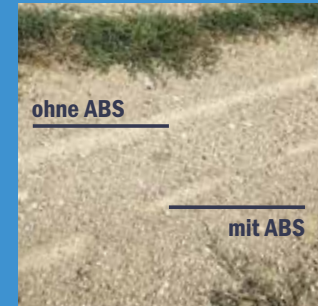
Bremsspur-Vergleich: Die ABS-Regeltätigkeit ist gut erkennbar.
