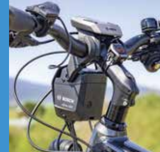
In diesem Kasterl unterhalb des Lenkers ist die Steuereinheit untergebracht.
