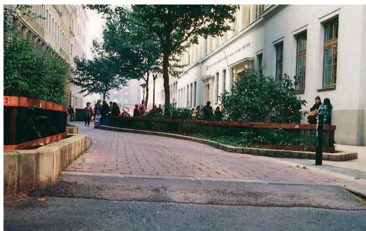
Abbildung 24: Der Versatz vergrößert die Pufferzone vor der Schule; durch die begrünte Gestaltung und eine zusätzliche Anhebung des Straßenniveaus im konkreten Beispiel wird der geschwindigkeitsreduzierende Effekt des Fahrbahnversatzes drastisch verstärkt
