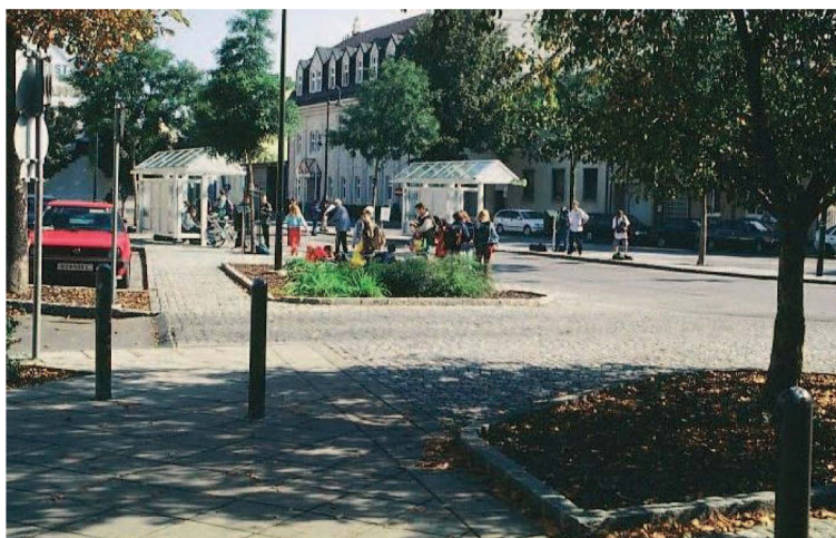
Abbildung 36: Beispiel für einen sicheren Zugang zur Haltestelle über eine Gehsteigdurchziehung
