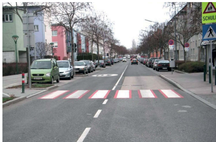
Abbildung 17: Schutzweg (im Beispiel mit roter Umrandung) und zusätzlicher Sicherung mittels Poller im Schulumfeld
