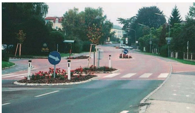
Abbildung 30: Die Mittelinsel verkürzt die Wartezeit und bietet eine sichere Aufstellmöglichkeit in der Straßenmitte
